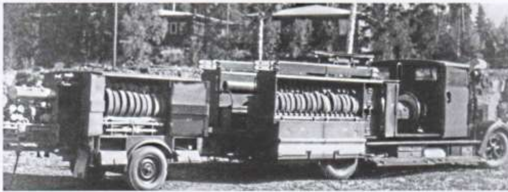
Met de slangenwagen met aanhang-motorspuit kon vanaf de pompende tankautospuit in snelreïnvvaart een toevoerslang worden uitgelegd vanaf de waterwinning, waarna de motorspuit daar druk op kon zetten. Foto: collectie Karl Rode
