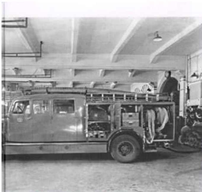
Omdat bij het starten van de diesel een grote roetwolk ontstond, die de hele remise van de brandweerkazerne vulde, werd aan de uitlaat een slang bevestigd, die eindigde op de binnenplaats aan de achterkant. Foto: Brandweer Amsterdam
