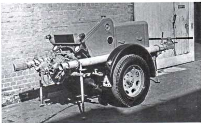
De standaard motorspuitaanhangert van Dennis. (Foto Dennis)
