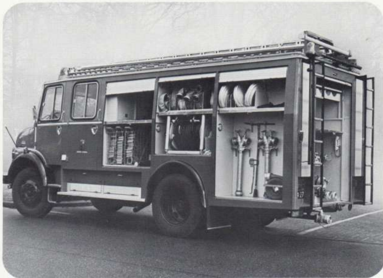
Zij-aanzicht van de door Berwi Winschoten, gebouwde tankautospuit voor de gemeente Driebergen.
